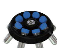
BC500-A3角式转子 50ml×8孔 6000rpm/5150×g
