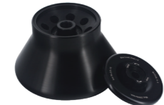
500P-A10角式转子 15ml×8孔 13000rpm/17570×g
