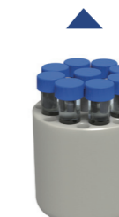
500P-1.3适配器 15ml×36孔 4000rpm/3120×g
