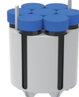
750R-1.4适配器 50ml×28孔 4000rpm/3400×g
