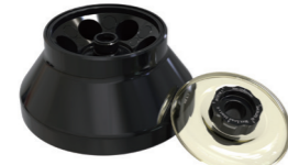
750R A-10角式转头 50ml×6孔 12000rpm/16500×g
